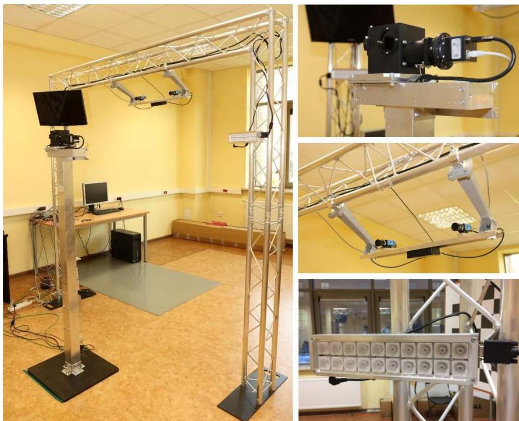
Rysunek 3.5: Zrealizowana bramka identyfikacji biometrycznej.
