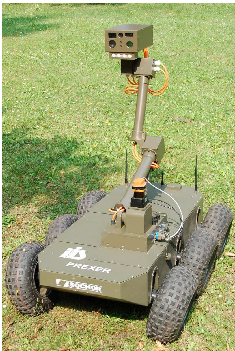
Rysunek 3.1: Robot mobilny pola walki zrealizowany w Instytucie Informatyki Stosowanej PŁ. (fot. Adam Wulkiewicz)
